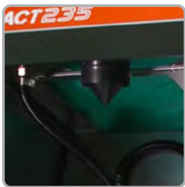
Atomizador de sistema Venturi
