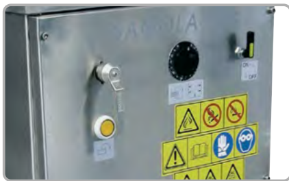
Maneta de apertura, encendido/apagado y temporizador en la puerta frontal.
