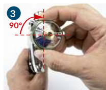
3 Montar el cabezal de aire y ajustar.
