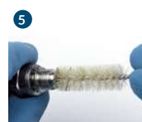
5 Limpiar la parte interior del pico fluido con el cepillo correcto.
