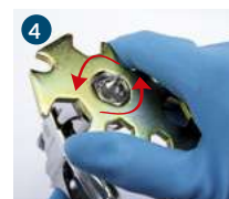
4 Retirar el pico desmontando con la llave auniversal.
