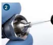
2 Limpiar el orificio de la boquilla central con un cepillo especial.
