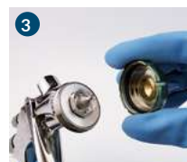
3 Retirar el cabezal de aire.
