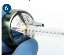
6 Limpiar el orificio central del cabezal de aire.
