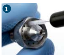
1 Limpiar los orificios pequeños con el cepillo especial.
