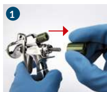
1 Retirar la tuerca de regulación fluido y el muelle de la aguja.
