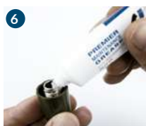
6 Engrasar la rosca de la tuerca de regulación fluido...
