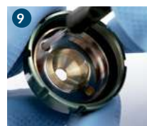
9 Limpiar la parte trasera del abanico.
