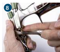
...y la válvula aire debajo del gatillo.
