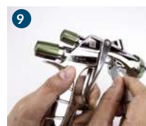
9 Ajustar (15° - 60°) la empaquetadura.
