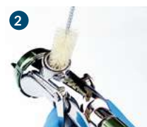
2 Limpiar la entrada de fluido con el cepillo trenzado.
