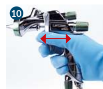
10 Comprobar el funcionamiento del gatillo y la aguja.
