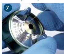
7 Limpiar los orificios pequeños con la aguja de limpieza.
